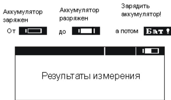
Рис. 13. Контроль состояния зарядки аккумуляторов
