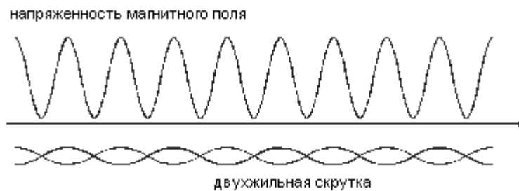
Рис.5 Уровень напряженности магнитного поля около двухжильного скрученного провода
