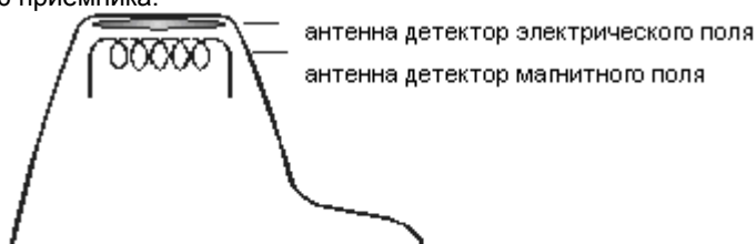
Рис.3 Размещение антенн детекторов в головке приемника
